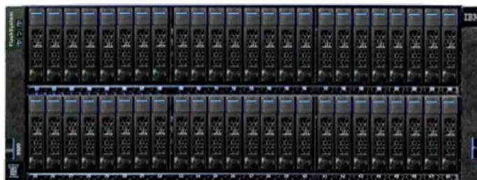
IBM FlashSystem 9500 mit 4U Bauhöhe
